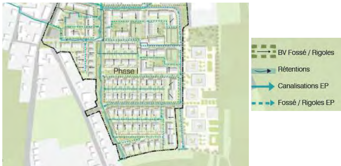
Abb. 5-7: Ausschnitt aus der Prinzipskizze „Regenwasser-Evakuierung“ des Plan directeur Erpeldange Centre (Planungsteam „Erpeldange-Centre“, Juli 2012 aus WW+ 2013)
