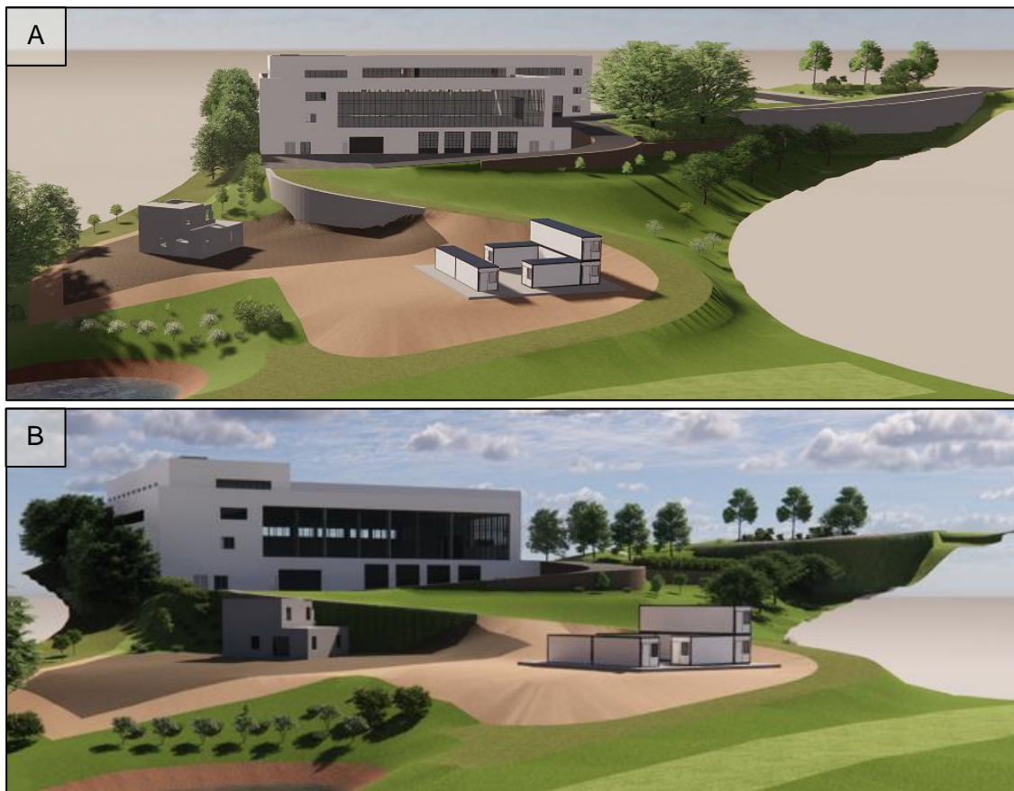
Abb. 37: 3D-Modell: Darstellung des Projektes ohne Begrünung der Stützmauern (A) und mit Begrünung der Stützmauern (B). Quelle: Beissel & Ruppert, Stand A: 27.01.2023, B: 31.01.2023.
