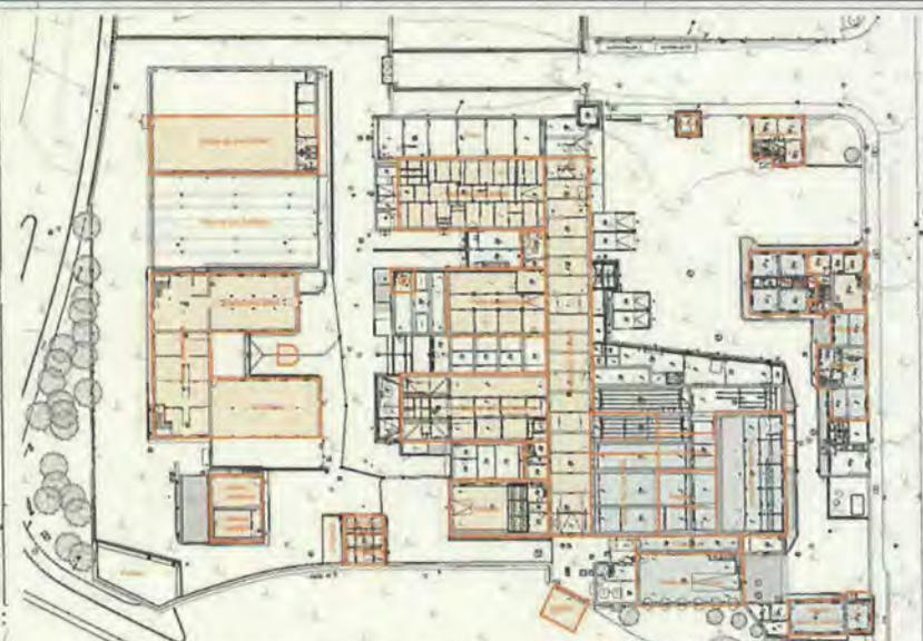
Deuxième phase de construction "Nouvel abattoir" 1929 superposition avec le levé détaillé de 2019 - 1/300
