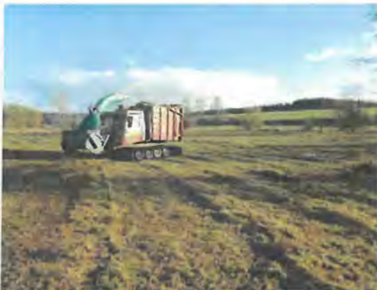
Abbildung 45. Maschinelle Mahd mit Aufsammeln des Mahdguts. In diesem Fall wurde auf der obersten Woltz mit einem umgebauten Pistenbully gearbeitet.
