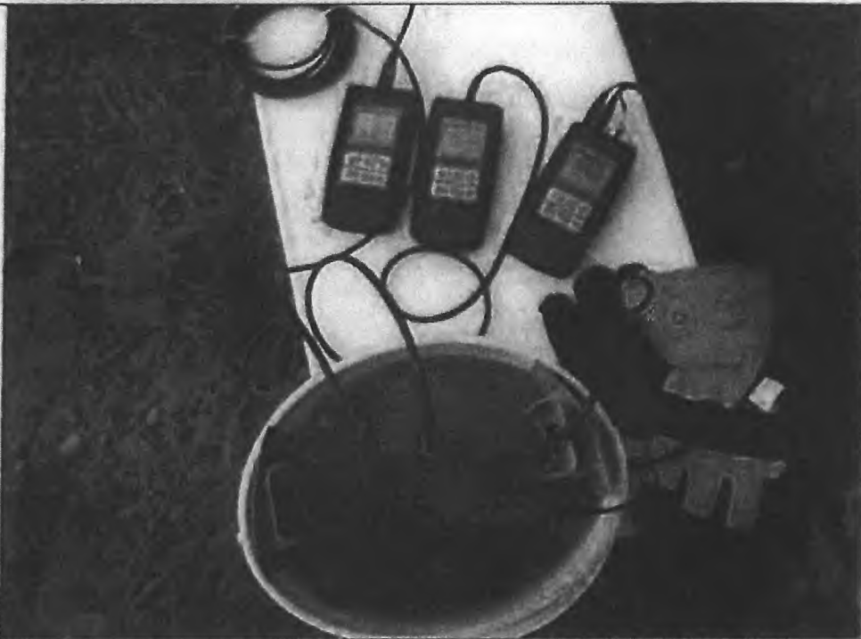
Abbildung 2: Schöpfprobe aus GWM3 vom 27.07.2016 - rötlichviolette Färbung durch Tracer
